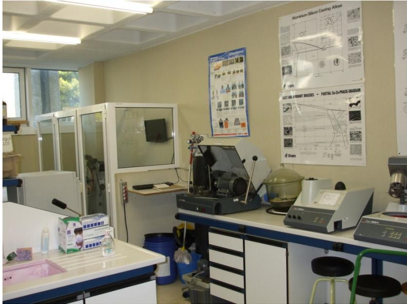
Máquinas de corte y lijadoras
