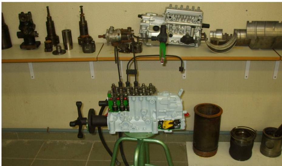
Bombas de inyección y componentes
