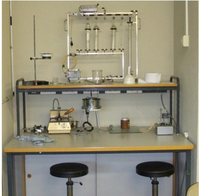
Viscosímetro y analizador de gases de combustión
